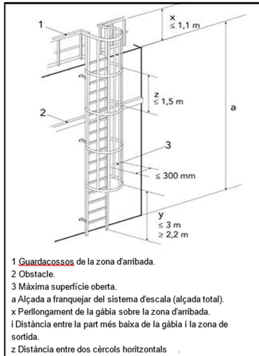
Figura 5. Dimensions dels elements d'una escala fixa dotada amb una gàbia de seguretat
